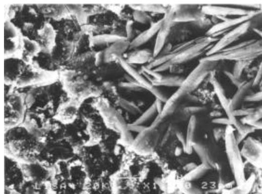
Ph. III.38 : Cristaux aciculaires de gypse (à droite) observés sur la face extérieure fracturée du verre G-17-1. (MEAB - électrons secondaires - x1000)
