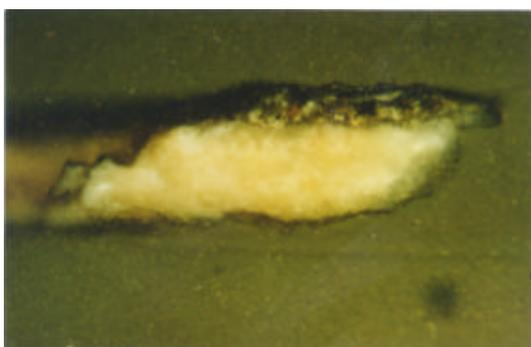
Ph. III.53 : Vue en section polie d'une croûte sulfatée contenant des particules colorées prélevée sur la face extérieure du verre G-17-1. La matrice vitreuse est altérée : structure blanche. (MO - x80)
