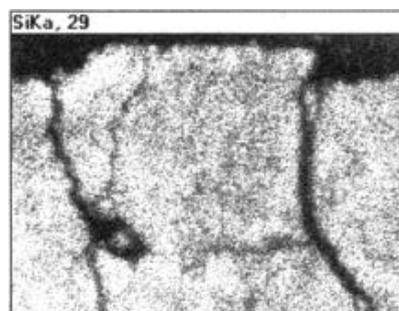
Ph. III.50 : Cartographie de la répartition de l'élément Si de la Ph. III.49. (MEAB - EDX - x1000)
