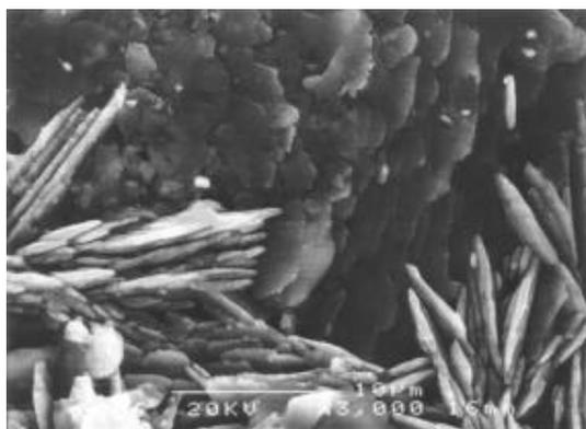
Ph. III.43 : Ensemble de cristaux aciculaires et lamellaires observés sur la face inférieure d'une croûte gypseuse prélevée sur la face extérieure du verre G-17-2.
